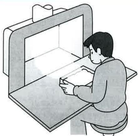
局所排気装置(外付け式)の例
